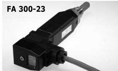
Display und 2 Schaltkontakte ▲ Schaltpunkt -40^{\circ}\text{C}_{\text{td}} , -35^{\circ}\text{C}_{\text{td}} 4..20 mA Analogausgang Bestell-Nr. 0699.3023 (siehe Set 6)
