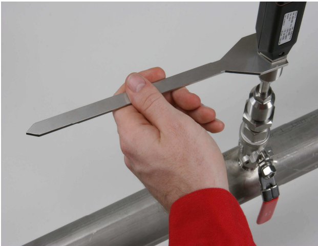
Bild 3 Lagegenauer Einbau der Messsonde
