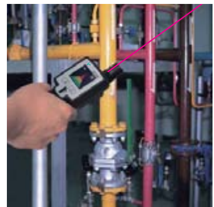
Der integrierte Laser erleichtert das Auffinden von Lecks.
