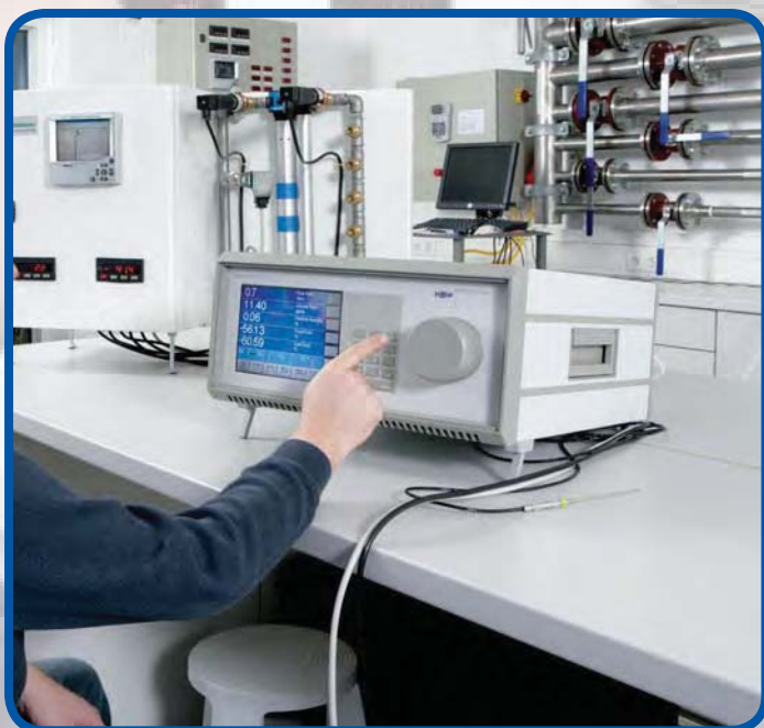
Kalibrierbereich: von -80 bis 20 °Ctd Genauigkeit der DKD-Referenz: 0,1 °Ctd
